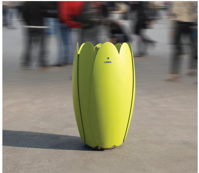
Poubelle composée de pétales juxtaposées en tôles d'acier zingué et thermolaqué dans une teinte à choix de la tabelle en pièce jointe. Base en acier inox; couvercle avec trou passant et serrure de sécurité. Anneau intérieur porte-sac capacité 75 litres. En option un contenant intérieur de capacité 50 litres est disponible. Le modèle peut être fixé au sol.
