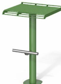
Siège monoposte avec ou sans dossier. Formé d'un tube portant et de siège en barreaux d'acier plein soudés. Le tout zingué à chaud et thermolaqué dans les teintes à choix de la tabelle en pièce jointe. Livré avec appuie-pieds en acier inox. Le modèle SI7S est muni d'un système rotatif partiel avec blocage et accoudoirs. Livrable à sceller ou avec plaque de base à visser au sol.
