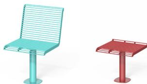
Siège monoposte et banc avec ou sans dossier. Formé d'un tube portant et de siège en barreaux d'acier plein soudés. Le tout zingué à chaud et thermolaqué dans les teintes à choix de la tabelle en pièce jointe. Livrable à sceller ou avec plaque de base à visser au sol.
