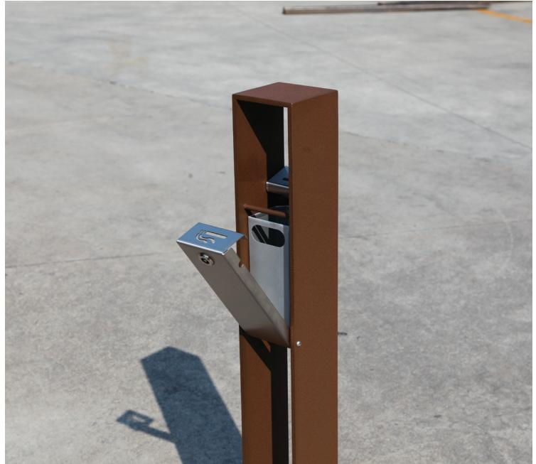
Cendrier sur pied constitué de plats d'acier soudés et zingués à chaud avec thermolaquage dans les teintes à choix selon tablette en pièce jointe. Egalement disponible en version acier corten livré pré-oxydé. Boîtier central en acier inox satiné; livré avec serrure triangulaire et conteneur intérieur. Le modèle peut être visser au sol. Visserie de fixation exclue.
