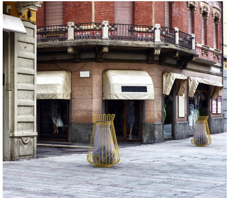
Poubelle formée d'un socle de base en tôle d'acier et d'une structure à la forme design constituée de fils continus d'acier plein calendrés et soudés. Le tout zingué à chaud et thermolaqué dans une teinte à choix de la tabelle en pièce jointe. Livrée avec anneau porte-sac et plaquette écrase-cigarette en acier inox. Capacité 110 litres. L'élément peut être fixé au sol.
