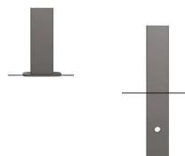
Banc bi-latéral, avec 2 supports en tube d'acier section 100x50 mm à sceller ou avec plaques à visser au sol; assise avec double dossier formé d'un tube principal de diamètre 60 mm et de tubes diamètre 16 mm. Le tout à choix entre acier zingué et thermolaqué dans une teinte de la tabelle en pièce jointe ou entièrement en acier inox.
