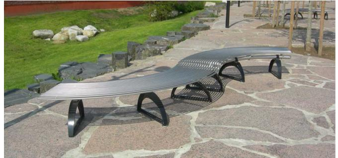
Banc entièrement en acier formé de 2 types de supports à choix; en tubes d'acier section 50x100 mm ou en fusion d'aluminium et forme d'arc. L'assise est composée d'un tube diamètre 60 mm, de plats d'acier sur lesquels sont soudés de tubes d'acier diamètre 16 mm. Le tout est zingué à chaud et thermolaqué dans une teinte à choix de la tabelle en pièce jointe. Une variante en acier inox est également disponible.
