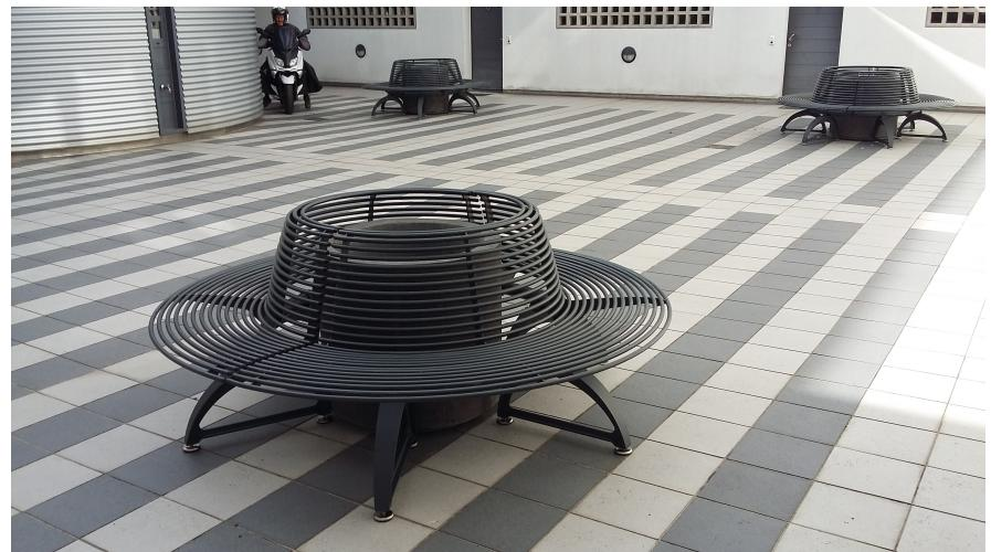
Banc entièrement en acier formé de 2 types de supports à choix; en tubes d'acier section 50x100 mm ou en fusion d'aluminium et forme d'arc. L'assise est composée d'un tube diamètre 60 mm, de plats d'acier sur lesquels sont soudés de tubes d'acier diamètre 16 mm. Le tout est zingué à chaud et thermolaqué dans une teinte à choix de la tabelle en pièce jointe. Une variante en acier inox est également disponible. En options des accoudoirs en fusion d'aluminium sont également disponibles.
