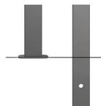
Banc entièrement en acier formé de 2 types de supports à choix; en tubes d'acier section 50x100 mm ou en fusion d'aluminium et forme d'arc. L'assise est composée d'un tube diamètre 60 mm, de plats d'acier sur lesquels sont soudés de tubes d'acier diamètre 16 mm. Le tout est zingué à chaud et thermolaqué dans une teinte à choix de la tabelle en pièce jointe. Une variante en acier inox est également disponible. En options des accoudoirs en fusion d'aluminium sont également disponibles.
