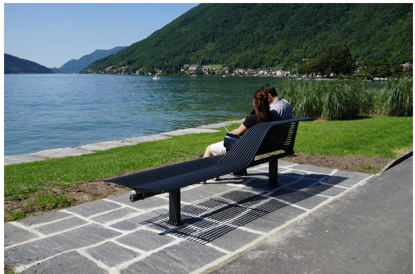
Banc bi-latéral, avec 2 supports en tube d'acier section 100x50 mm à sceller ou avec plaques à visser au sol; assise avec double dossier formé d'un tube principal de diamètre 60 mm et de tubes diamètre 16 mm. Le tout à choix entre acier zingué et thermolaqué dans une teinte de la table de la pièce jointe ou entièrement en acier inox .
