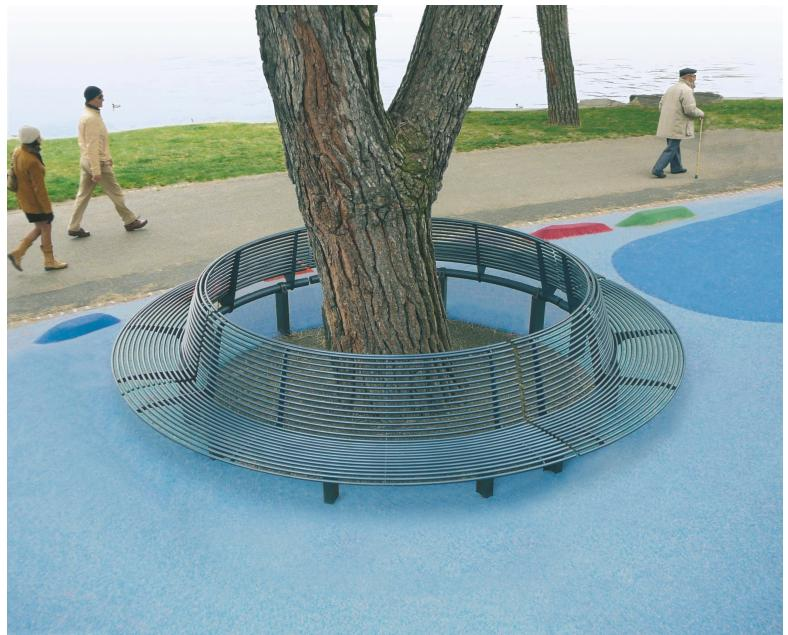
Banc entièrement en acier formé de 2 types de supports à choix; en tubes d'acier section 50x100 mm ou en fusion d'aluminium et forme d'arc. L'assise est composée d'un tube diamètre 60 mm, de plats d'acier sur lesquels sont soudés de tubes d'acier diamètre 16 mm. Le tout est zingué à chaud et thermolaqué dans une teinte à choix de la tabelle en pièce jointe. Une variante en acier inox est également disponible. En options des accoudoirs en fusion d'aluminium sont également disponibles.
