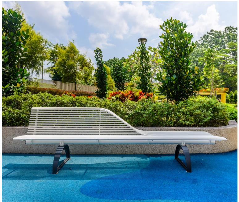
Banc bi-latéral, avec 2 supports en fusion d'aluminium et assise avec double dossier formé d'un tube principal de diamètre 60 mm et de tubes diamètre 16 mm. Le tout à choix entre acier zingué et thermolaqué dans une teinte de la tabelle en pièce jointe ou entièrement en acier inox . Le modèle peut être posé librement ou livré avec des plaquettes de fixation au sol.
