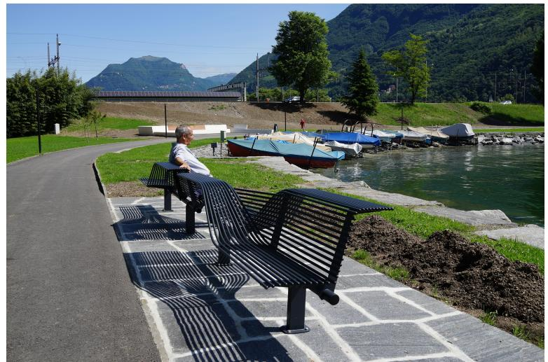
Banc bi-latéral, avec 2 supports en fusion d'aluminium et assise avec double dossier formé d'un tube principal de diamètre 60 mm et de tubes diamètre 16 mm. Le tout à choix entre acier zingué et thermolaqué dans une teinte de la tabelle en pièce jointe ou entièrement en acier inox . Le modèle peut être posé librement ou livré avec des plaquettes de fixation au sol.
